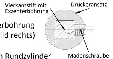
2. Die Bohrschablone auf den Drückerstift stecken. Wir empfehlen Ihnen den Rundzylinder im Vorfeld einzubauen, somit unterstützt Sie dieser beim Ausrichten der Schablone.
