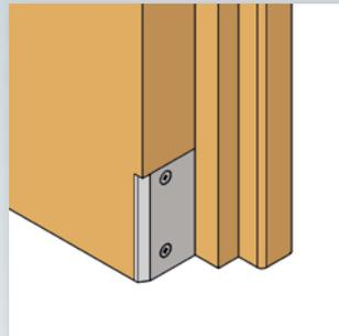
Exemple de montage plaque de coin jeu X3, aluminium, montée sur encadrement
