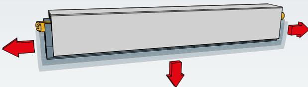
3 mouvements d'étanchéification simultanés : vers la gauche, vers la bas et vers la droite
