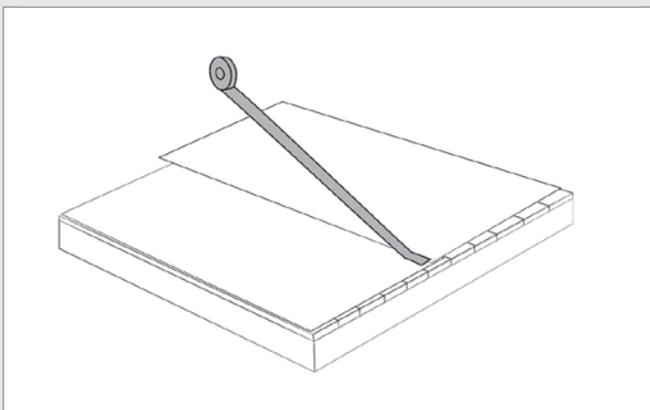
Abdichtung von Überlappungen an Fertigbauteilen
