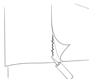
Scellement recouvrements de membrane à la colle
