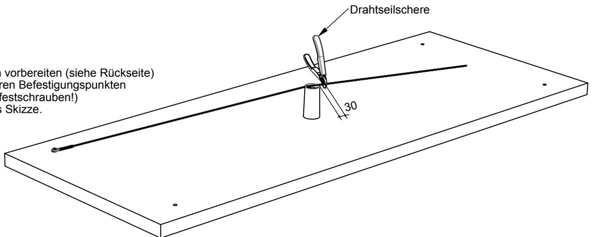
6. Seile durch den Spannzylinder führen.
