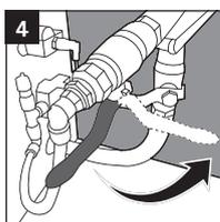
**4** Fermer la vanne sphérique « air comprimé ».
