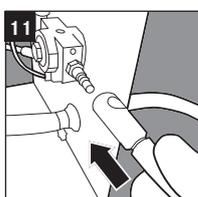
**11 Raccorder le tuyau à air comprimé.**
