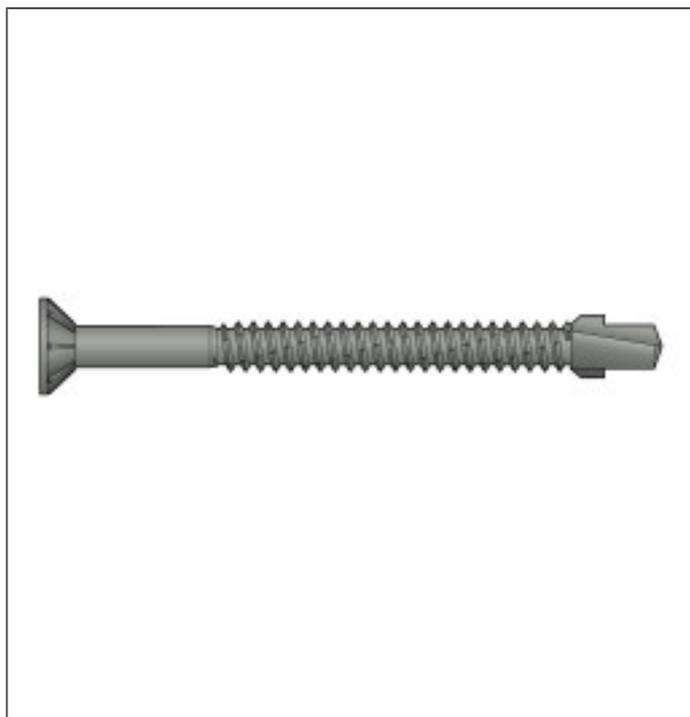
Les vis en bandes TBG simple filetage ont été étudiées pour faciliter la mise en oeuvre de panneaux bois sur structure acier ou aluminium (épaisseur 6 mm maximum).
