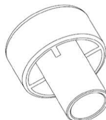
**Verfüllstutzen für Überkopf- oder Horizontalmontage**
