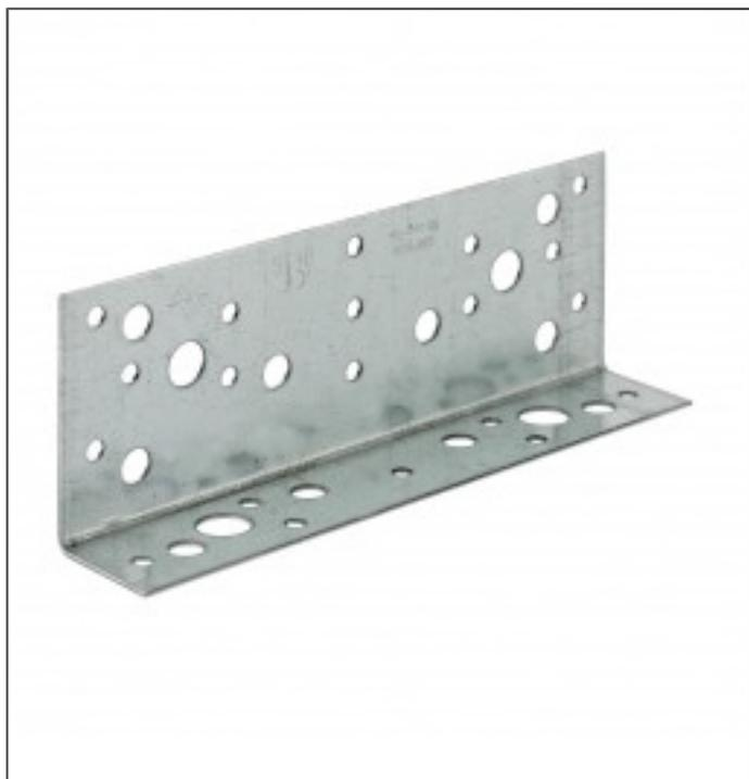
Die BNV Winkelverbinder werden für die Verankerung von Verblockungen in Aussteifungsfeldern eingesetzt, um die Kräfte aus den Verbänden in die Ringbalken oder Deckenplatten einzuleiten. Die Verbinder können auch zum Anschluss von Längskräften bei Wandtafeln eingesetzt werden.
