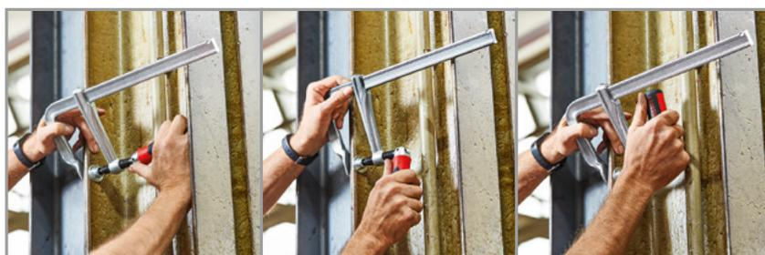
Strettoio a vite in acciaio GZ con impugnatura ribaltabile
