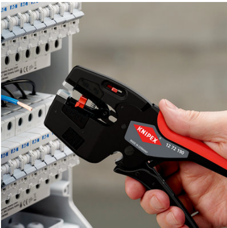
Die Zwangssperre stellt beim Crimpen immer den perfekten Anpressdruck sich
