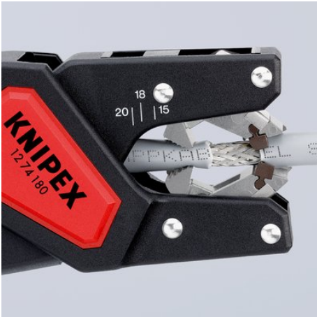
Einfaches Ablesen der gewünschten Abisolierlänge
