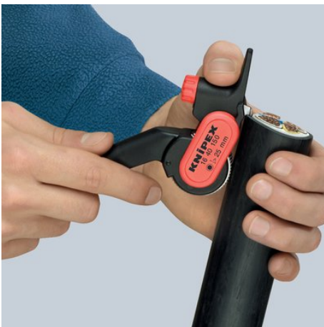
Posizionamento dell'utensile per taglio longitudinale
