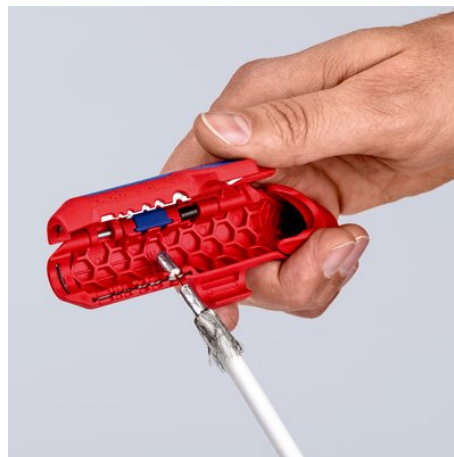
Dénudage d'un câble coaxial
