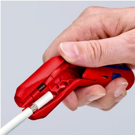
Dégainage d'un câble coaxial
