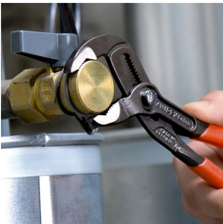
Les dentures orientées dans le sens inverse de la rotation entraînent un effet autobloquant et empêchent tout glissement sur la pièce.
