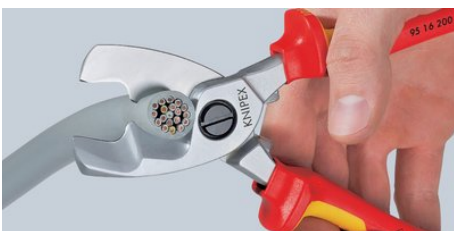
Nachschnitt: Nachdem der Mantel des Kabels im vorderen Profil durchgeschnitten wurde, werden die Leiter im hinteren Profil durchtrennt. Vorschnitt vorn, Nachschnitt hinten - so schneidet es sich leichter.
