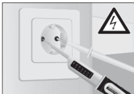
Afferrare l'apparecchio base (+) con la mano destra e la seconda punta di prova (-) con la mano sinistra. Portate le punte sui contatti che devono essere controllati (p.e. linee, prese, ecc.).
