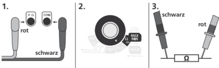
1. Schließen Sie die rote Messspitze an die Eingangsbuchse V  $\Omega$  (12) und die schwarze Messspitze Eingangsbuchse COM (8) an.
