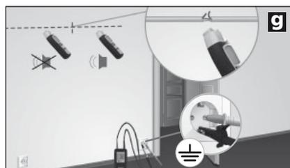
Se si lavora con un trasmettitore, il punto di interruzione della linea potrebbe non essere rilevato così precisamente a causa di possibili disturbi del campo elettromagnetico, vedi figura g. In tal caso, il ricevitore visualizza il segnale di trasmissione dopo l'interruzione della linea con un segnale sensibilmente diminuito. L'interruzione si trova nel punto in cui inizia la diminuzione del segnale.
