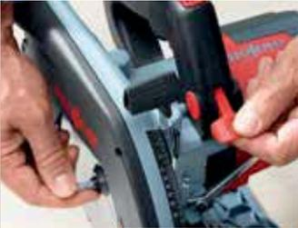
Zum Sägeblattwechsel wird das Sägeblatt der K 65 einfach per Knopfdruck arretiert und dabei automatisch die Einschaltsperrung aktiviert. Das Sägeblatt lässt sich dann mit dem am Gerät befestigten Sechskantschlüssel einfach und schnell austauschen.
