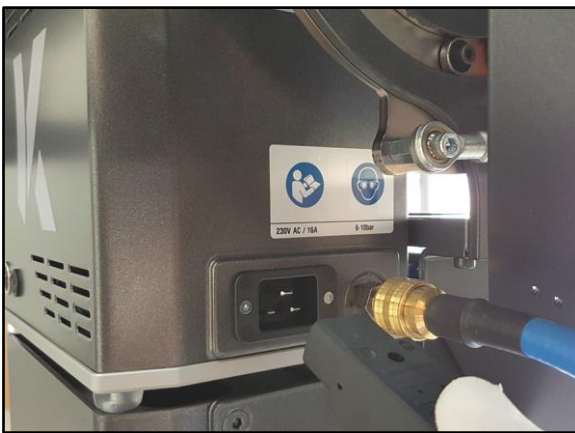
Abbildung 12 - Druckluft und Stromanschluss
