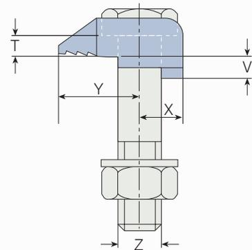
Baufaufsichtlich zugelassene Klemme auch für dynamische Belastungen (z.B. Krane). Hohe Sicherheit durch Verdrehsicherungen am Trägerflansch. Montageerleichterung durch Schraubenkopfaufnahme. Flanschneigungen bis zu 8° möglich. Die Nockenhöhe ist korrekt ausgewählt, wenn der Flansch allein mit der Klemmfläche K geklemmt wird und die Klemmennase frei steht. Für größere Klemmdicken werden spezielle Unterlegteile eingesetzt. (siehe Auswahltabellen Seite 15).
