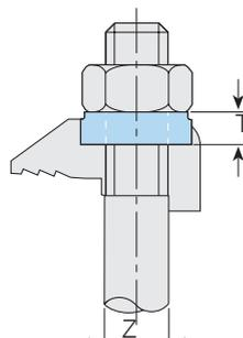
Einlegeteil zum Ausfüllen der Vertiefung von Typ A. Dadurch entsteht eine ebene Auflage zum Anziehen der Mutter. Bei Ermittlung der Schraubenlänge Maß T addieren.
