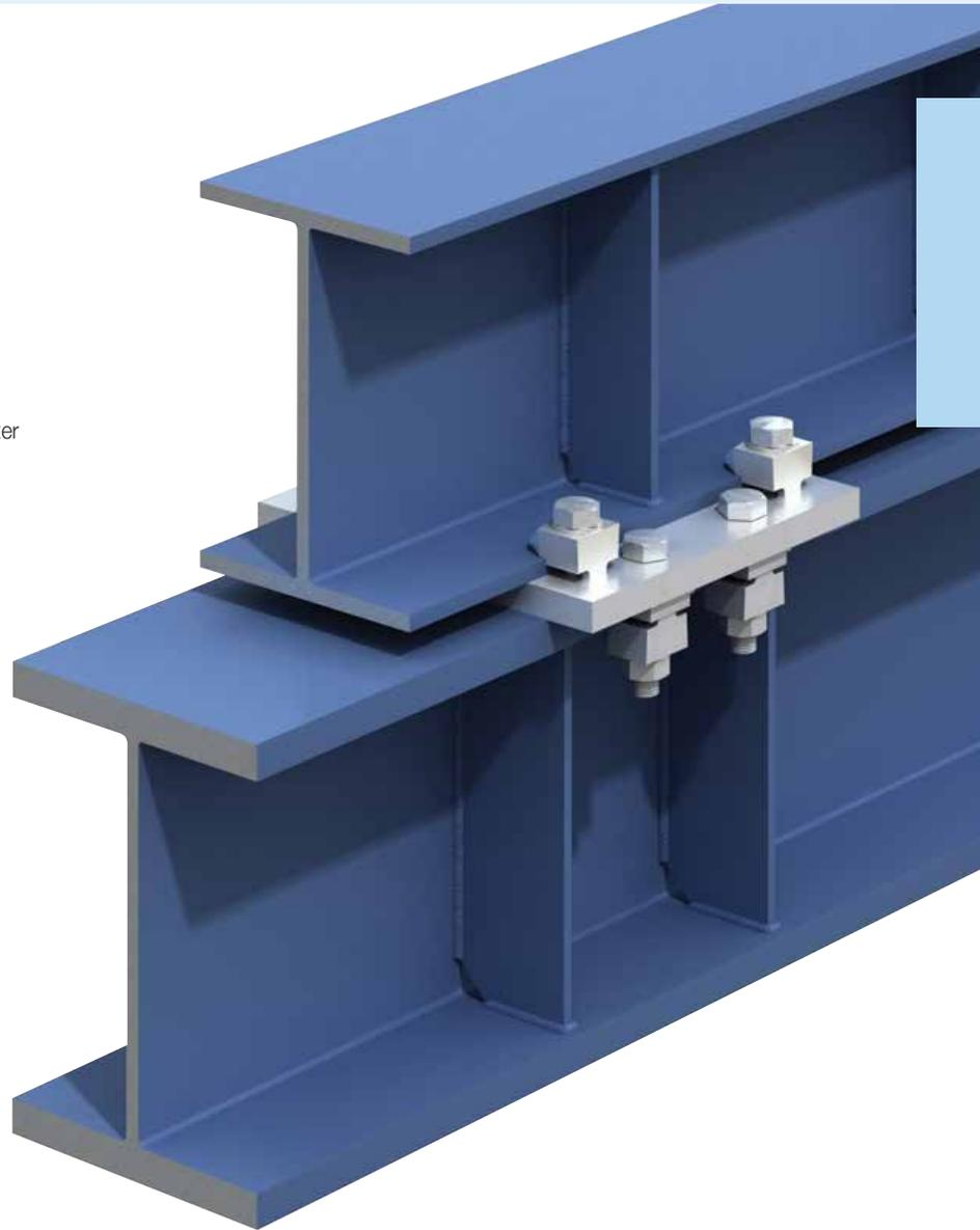
Bauaufsichtlich zugelassene Klemme auch für dynamische Belastungen (z.B. Krane). Hohe Sicherheit durch Verdrehsicherung am Trägerflansch. Alternativ zur Schraube sind Gewindestangen, Rundbügel usw. möglich. Flanschneigungen bis zu 8° möglich. Die Nockenhöhe ist korrekt ausgewählt, wenn der Flansch allein mit der Klemmfläche K geklemmt wird und die Klemmennase frei steht. Für größere Klemmdicken werden spezielle Unterlegteile eingesetzt. (siehe Auswahltabelle Seite 15).
