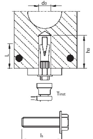
$t_{fix}$  = Anbauteildicke       $b_{St}$  = Stegbreite
