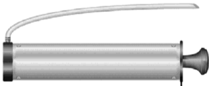
Ausblaspumpe (Volumen 750ml) Bohrerdurchmesser (d 0 ): 10 mm bis 20 mm Bohrlochtiefe h 0 ≤ 10 d nom siehe Anhang B4
