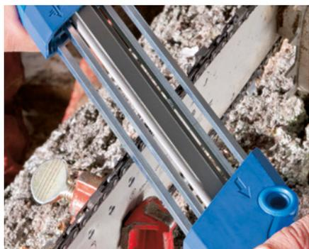
Les affûteuses de PFERD sont parfaitement adaptées à affûter manuel des chaînes de tronçonneuse. L'affûtage manuel est plus rentable et soigneux que l'affûtage mécanique. Il permet de rallonger la durée d'utilisation de la chaîne de tronçonneuse.
