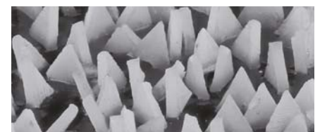
Orientamento ottimale del granulo VICTOGRAIN
