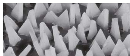
Orientamento ottimale del granulo VICTOGRAIN
