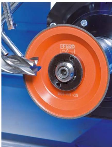
Les disques abrasifs diamant et CBN à liant à résine synthétique sont souvent utilisés pour le meulage des outils en carbure ou HSS, mais aussi dans d'autres processus de meulage pour la production. Ils s'utilisent aussi bien à sec que sous arrosage.
