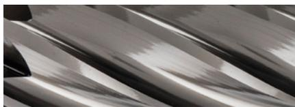
L'utilizzo di frese con il rivestimento HICOAT HC-NFE di PFERD impedisce che i trucioli intasino le gole della fresa durante la lavorazione di leghe di alluminio teneri. Questo favorisce una maggiore durata dell'utensile e permette di ottenere una superficie di qualità elevata.
