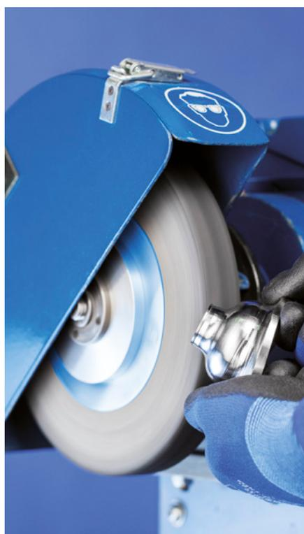
Le ruote abrasive compatte PNK sono costituite da più strisce in Vlies fortemente ondulate, disposte a spirale attorno a un nucleo. Le onde proteggono il Vlies, influenzandone la durata e il comportamento in asportazione. Grazie allo speciale sistema legante si ottengono utensili in Vlies con ottima finitura superficiale, elevata asportazione e lunga durata.
