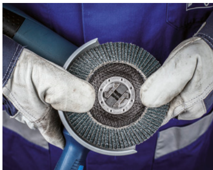
Premete leggermente l'utensile verso il basso fino a quando si sente lo scatto.
