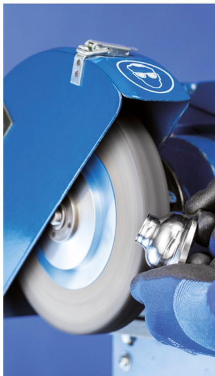
Les outils en non tissé POLINOX PNK se composent d'un non-tissé (Vlies) abrasif enroulé autour d'un noyau et moussé. La mousse protège le non-tissé et prolonge sa durée de vie tout en modifiant ses propriétés abrasives. Ce liant spécial permet de créer des roues en non-tissé offrant une très bonne finition de surface, une capacité élevée d'enlèvement de matière et une longue durée de vie.
