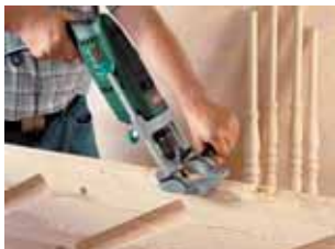
schwenkbare 2-Säulenführung mit Skalierung für Bohrungen bis +/- 45°
