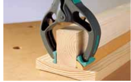
bewegliche Spannbacken passen sich dem Werkstück an
