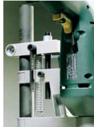
Bohrtiefeneinstellung durch Tiefenstopp
