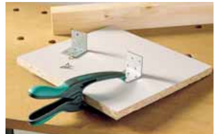
große Spanntiefe erlaubt auch Fixieren in randfernen Bereichen
