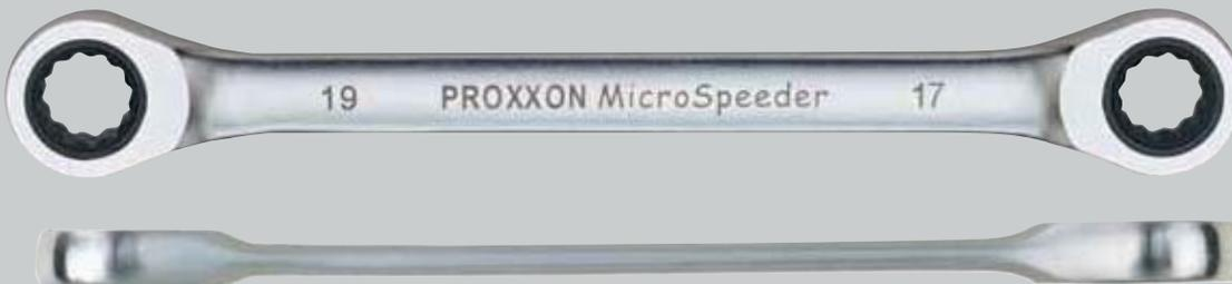
Zum Motorenaus- und -einbau, an Automatik-Getrieben, an der Hinterachse usw. Ratschenfunktion mit 72-zahnigem Innenring aus hochlegiertem Spezialstahl. Der Antrieb erfolgt bereits bei einer Hebelbewegung von 5°. Schäfte aus CrV-Stahl mit optimalem Oberflächenschutz: 2 x vernickelt und 1 x mattverchromt. Mit Laserbeschriftung und deutlich lesbaren Schlüsselweiten.
