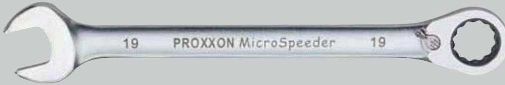
Ein Umlegen des um 15° abgewinkelten Kopfes (ringseitig) ist nicht möglich. Deshalb hat dieser Schlüsseltyp eine Hebelumschaltung für Rechts- und Linkslauf. Ideal zum Schrauben an Planflächen.
