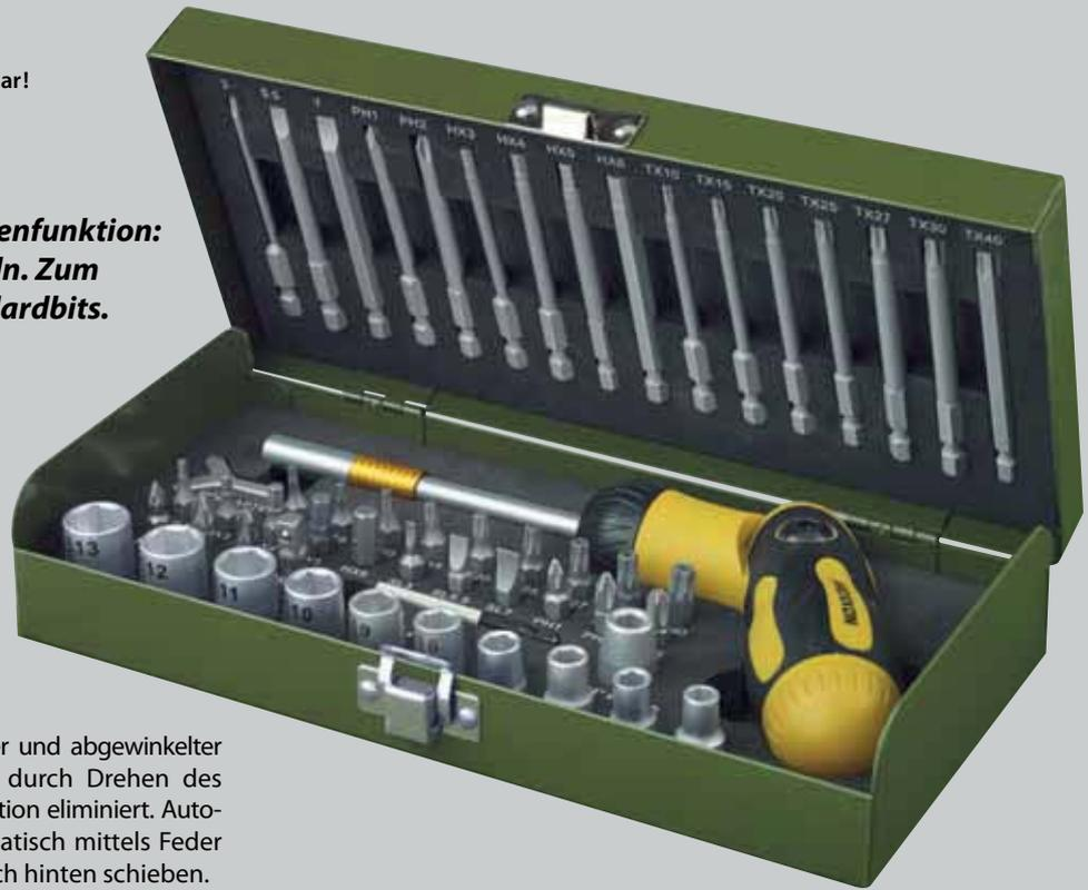
Verrastung des Griffes durch Knopfdruck in normaler und abgewinkelter Version. Umschaltung von Rechts- auf Linkslauf durch Drehen des Schaltringes. In Mittelstellung wird die Ratschenfunktion eliminiert. Auto-lock-System: Bits werden nach Einschieben automatisch mittels Feder und Magnet fixiert. Zum Entnehmen Auswerfer nach hinten schieben.
