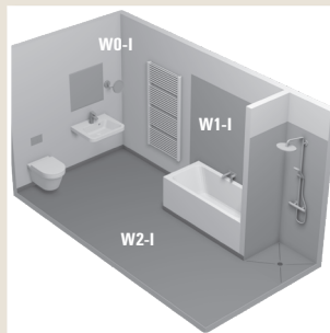
Häusliches Bad mit Badewanne und bodengleicher Dusche ohne Duschtrennung.
