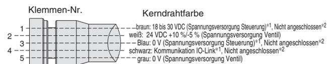
Anschlüsse (IO-Link) \*1 Bei Verwendung als Kommunikationskabel IO-Link
