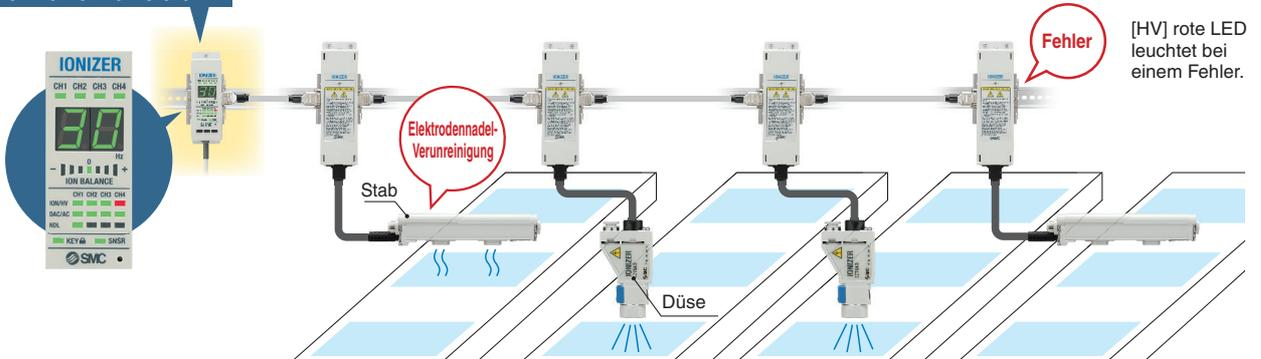
Der Controller und das Hochspannungsversorgungsmodul können getrennt voneinander montiert werden.
