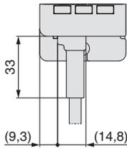
Wenn das Netzanschlusskabel angeschlossen ist
