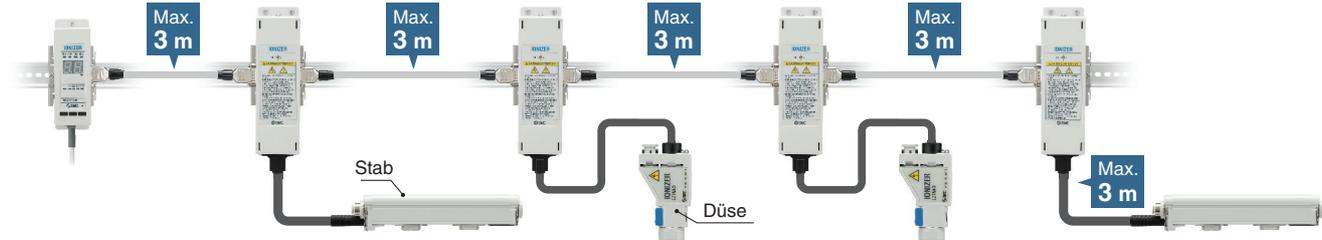
Die vereinfachte Installation der einzelnen Module wird dank Steckeranschluss ermöglicht.
