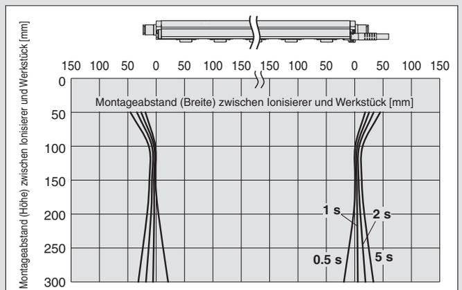
\* Die Kennlinien zum Abbau der statischen Elektrizität basieren auf Messwerten bei geladener Platte (Abmessungen: 150 mm x 150 mm, Kapazität: 20 pF) gemäß US-ANSI-Standards (ANSI/ESD STM3.1-2006). Verwenden Sie diese Daten bei der Typenauswahl bitte nur als Referenz, da die Werte je nach Material und/oder Größe des Objekts abweichen können.
