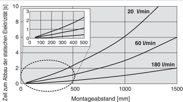
① Bereich des Abbaus der statischen Elektrizität (Zeit zum Abbau der statischen Elektrizität von 1000 V auf 100 V)
