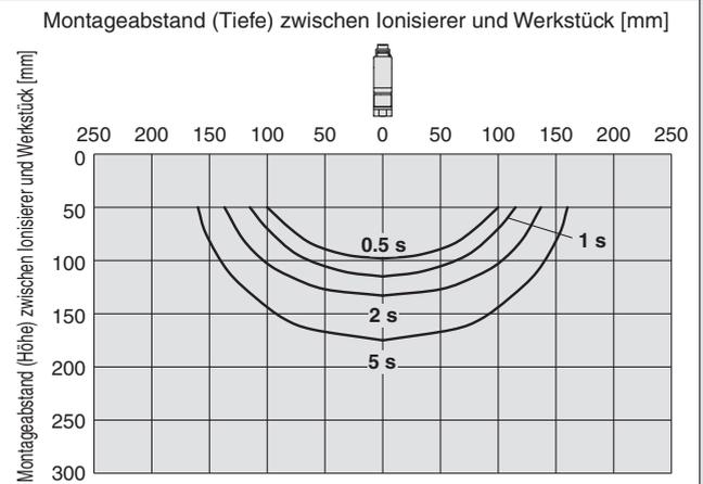
2) Kassette für den schnellen Abbau statischer Elektrizität, Versorgungsdruck: 0,5 MPa
