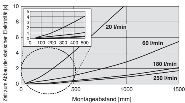
Kassette für den Abbau statischer Elektrizität in Energiesparausführung
