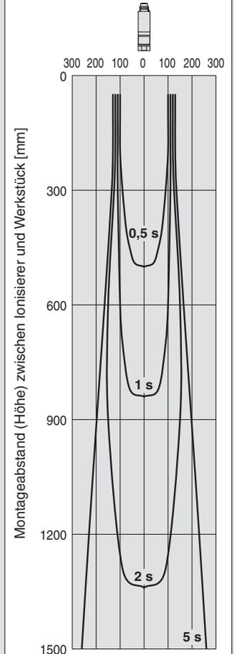
\* Die Entladungskennlinien basieren auf den Daten einer geladenen Platte (Abmessungen: 150 mm x 150 mm, Kapazität: 20 pF) gemäß US- ANSI-Standards (ANSI/ESD STM3.1-2015). Verwenden Sie diese Daten bei der Typenauswahl bitte nur als Richtlinie, da die Werte je nach Material und/oder Größe des Objekts abweichen können.
