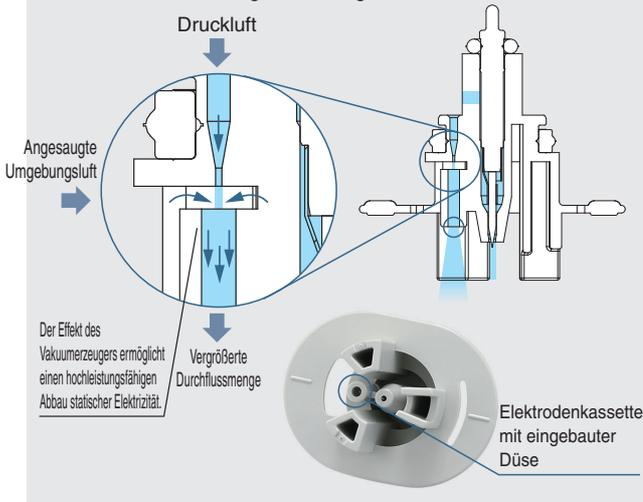
**Durchfluss für Montageabstand der einzelnen Kassetten**
