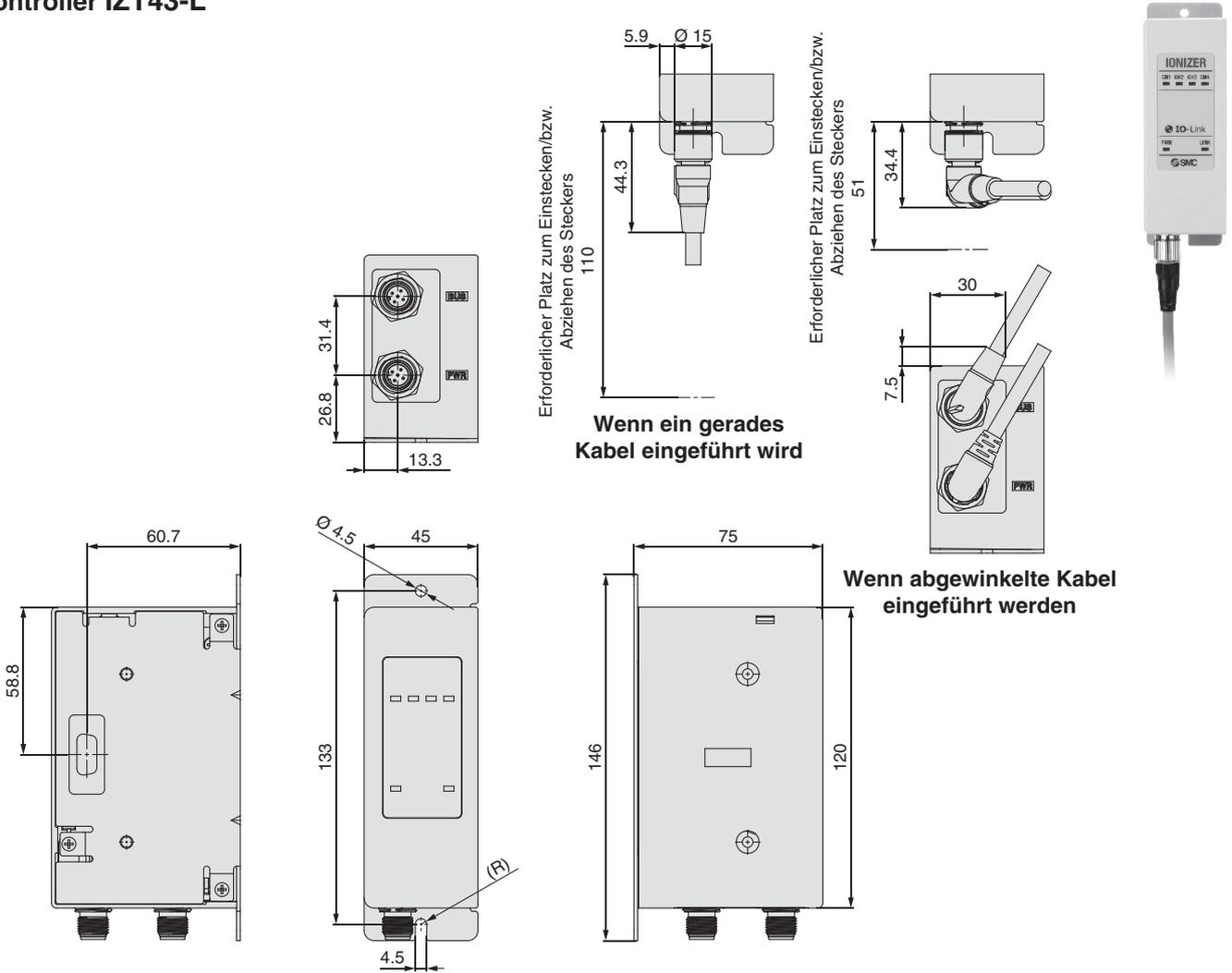
**Bei Verwendung des DIN-Schienen-Anbausatzes (IZT40-B1)**
