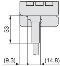
Wenn das Netzanschlusskabel angeschlossen ist
