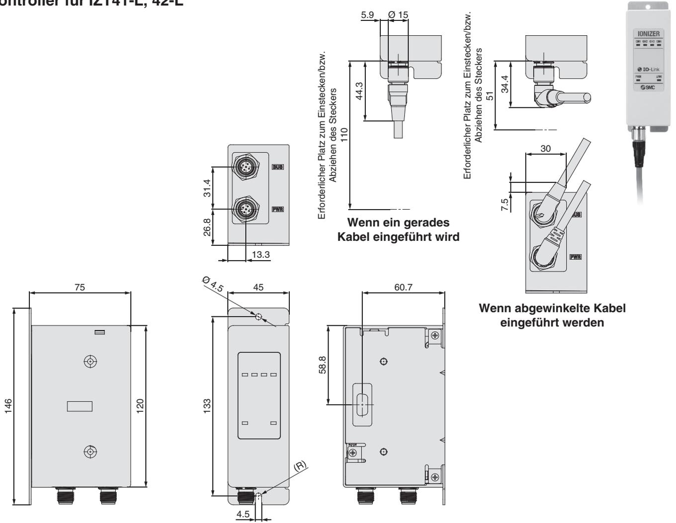
**Bei Verwendung des DIN-Schienen-Anbausatzes (IZT40-B1)**
