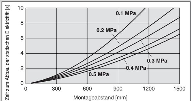
\* Die Kennlinien zum Abbau der statischen Elektrizität basieren auf Messwerten bei geladener Platte (Abmessungen: 150 mm x 150 mm, Kapazität: 20 pF) gemäß US-ANSI-Standards (ANSI/ESD STM3.1-2006). Verwenden Sie diese Daten bei der Typenauswahl bitte nur als Referenz, da die Werte je nach Material und/oder Größe des Objekts abweichen können.
