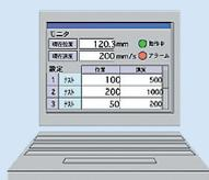
Fenêtre de paramétrage des données de positionnement
