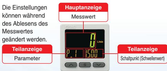
Die Teilanzeige kann durch Drücken der UP-/DOWN-Tasten umgeschaltet werden.
